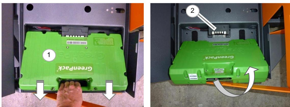
Abbildung 15 Entnehmen des Akkus aus dem Fahrzeug
